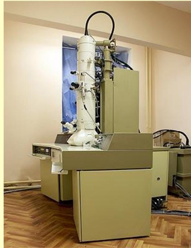
Просвечивающий электронный микроскоп
