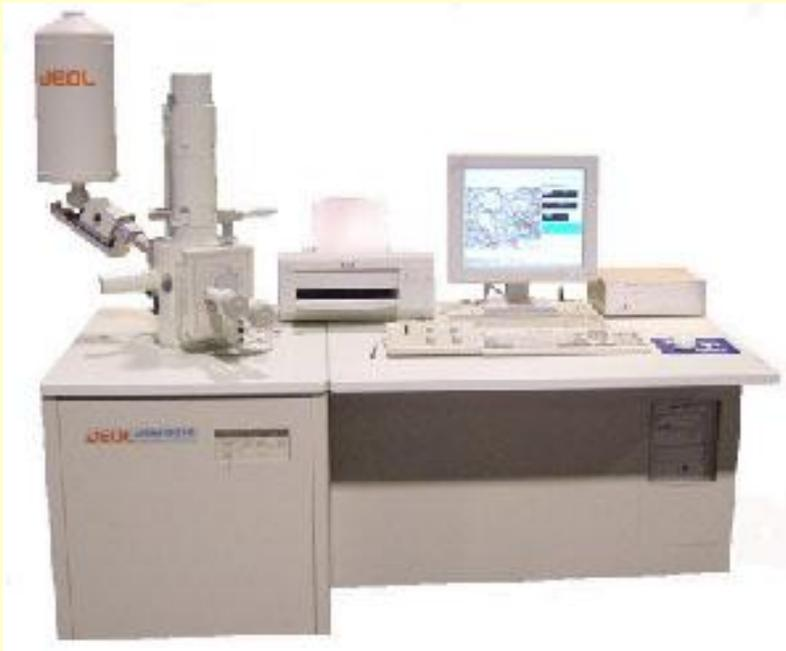
Сканирующий электронный микроскоп
