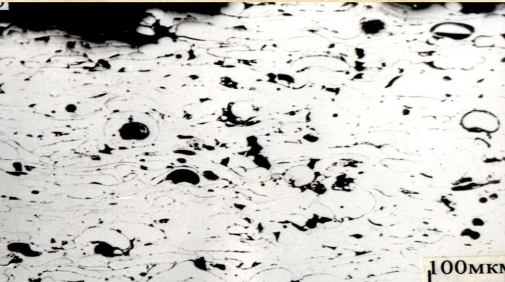
Фотография газо-термического покрытия с порами
