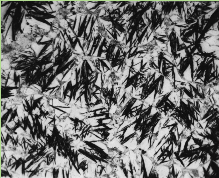
Микроструктура стали 45 после закалки
